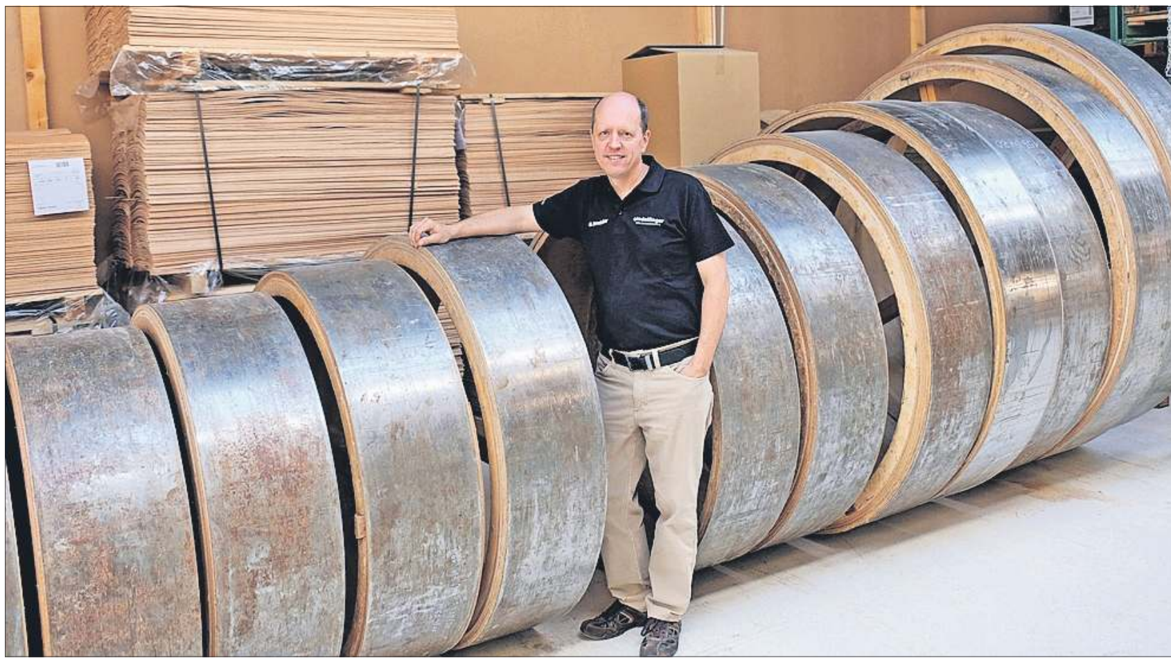
Firmenchef Bernd Berstecher vor teils mannsgrößen Spannformen. Die Holzringe der gleichnamigen Sindelfinger Firma werden um diese Stahlbänder herum gewickelt. Sie sind ein wichtiges Werkzeug für die Fertigung in der Manufaktur, aber längst nicht das einzige. Fotos: red/sd
